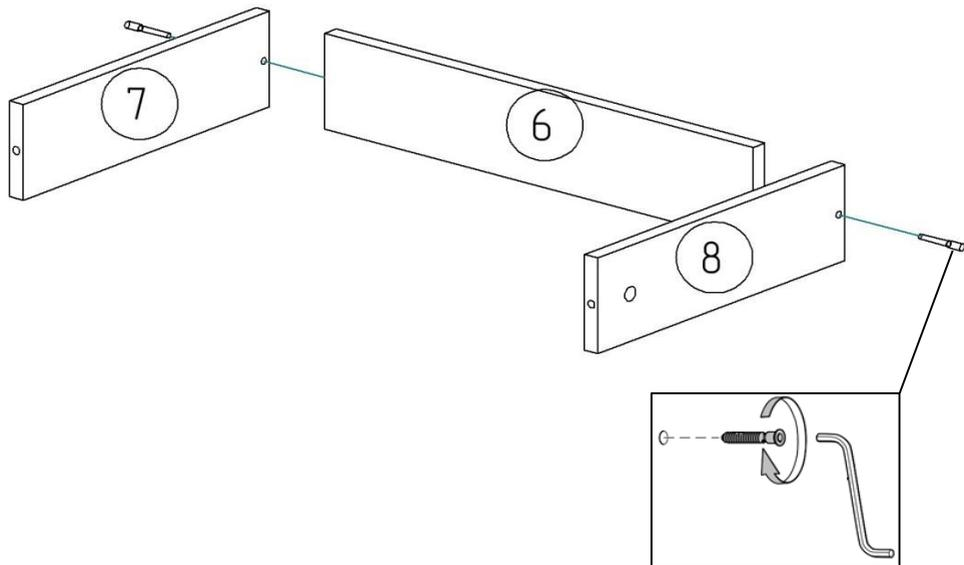
1. Соедините детали 6, 7, 8 с помощью винтов евро 7x50 мм.
