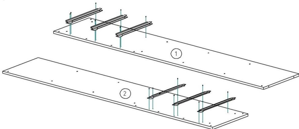
8. Установите на детали 1, 2 направляющие роликовые с помощью саморезов 3,5x16 мм.
