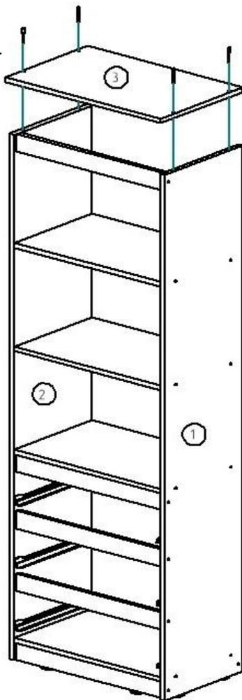
12. Соедините детали 1, 2 с деталью 3, с помощью винтов евро 7x50 мм.
