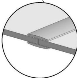
13. Закрепите детали 10, 11, 12 на каркасе стеллажа с помощью гвоздей 2,0x25 мм, предварительно соединив детали 12 между собой брусом соединительным.
