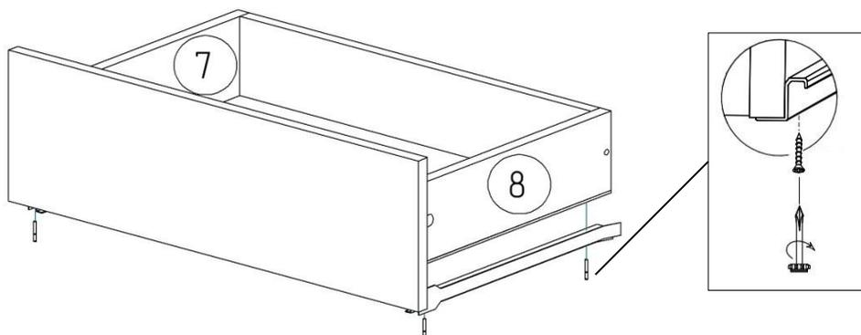
5. Закрепите направляющие роликовые с помощью саморезов 4x25 мм на деталях 7, 8.
