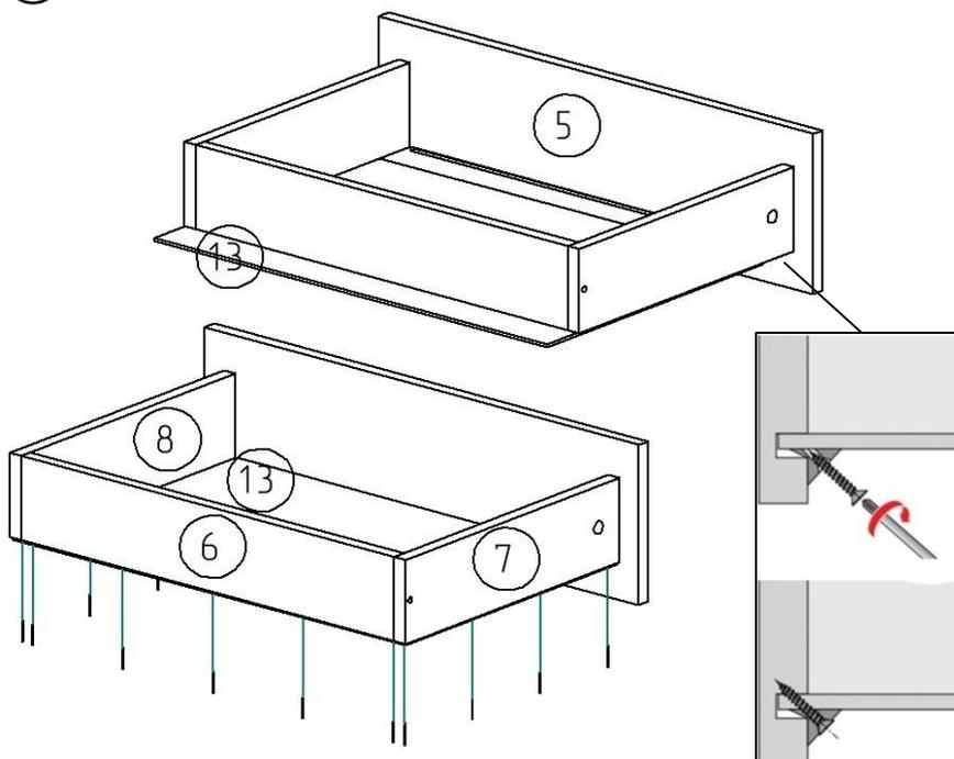
4. Установите деталь 13 в паз детали 5, закрепите ее с помощью гвоздей 2,0x25 мм на торцах деталей 6, 7, 8, а на деталь 5 закрепите уголками мебельными и саморезами 3,5x20 мм (по 3 уголка на каждый фасад).
