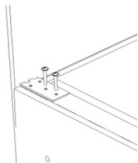
4. Закрепить опору колесную на внутренней стороне сиденья как показано на (рис), при помощи винтов М6х20 – 4шт.
