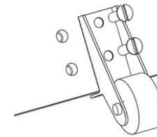
5. Установить опоры на боковину большую согласно (рис) при помощи саморезов – 4 шт.
