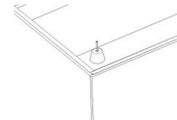
8. Закрепить боковину малую на короб оттоманки при помощи болтов М8х45 – 2 шт. Болты крепить через усовые гайки.
