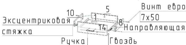
1. Соедините детали 5, 8, 10 с помощью винтов евро 7x50 мм.
