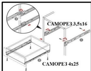
Рис. 1 Установка направляющих
