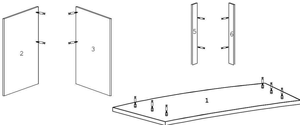
8. Соединить детали 2, 3, 4, 5 и 6, затянуть эксцентрики по часовой стрелке до упора.
