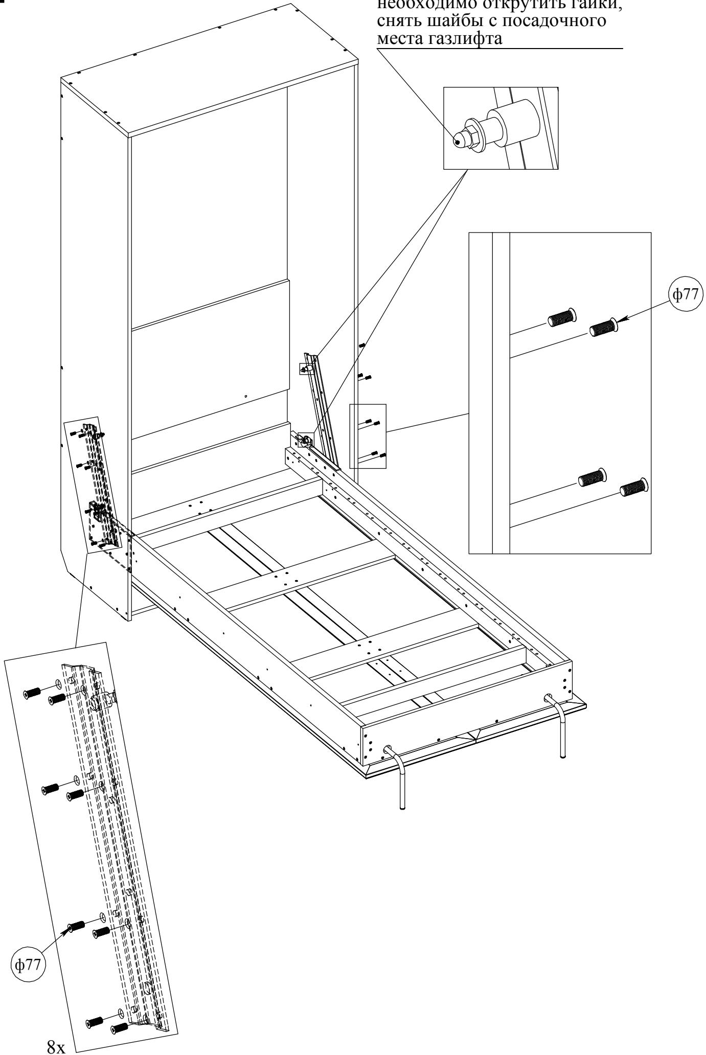
**ВНИМАНИЕ! Амортизатор находится под давлением! Натяжную ленту удалять только после монтажа!**
